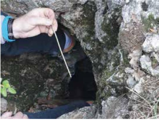
Photographie 3 : Test de courant d'air à l'encens à l'entrée d'origine de la cavité avant sa désobstruction. Cliché Eric Elguero
